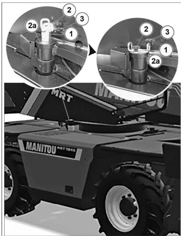
Figura 134: Bloqueo de la rotación de la torreta
